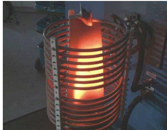
Figure 1.1: Ejemplos de Hornos de Inducción. Fotografías tomadas de [www.rdoinduction.com](http://www.rdoinduction.com).
