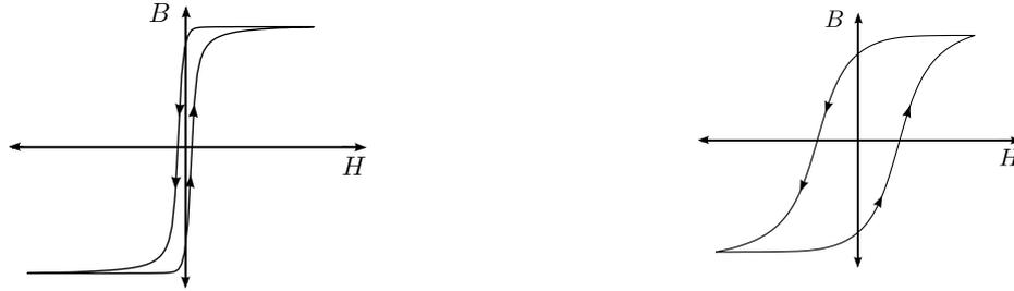
Figure 1.4: Ejemplos de ciclos de histéresis en un material blando (izquierda) y duro (derecha).
